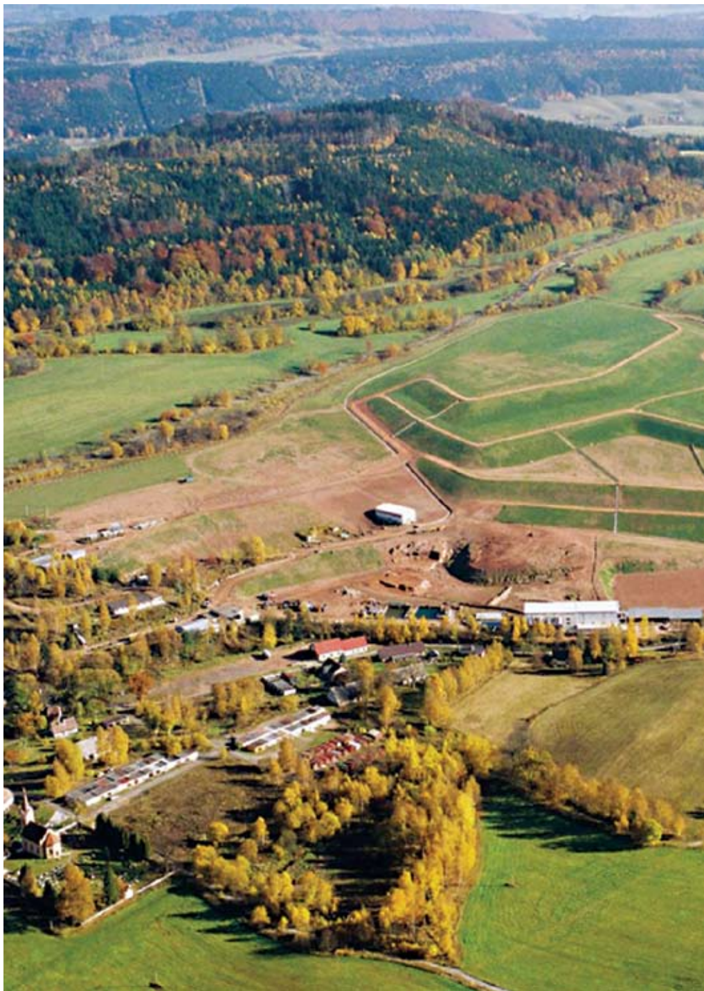
Sanace hořícího odvalu bývalého Dolu Kateřina v Radvanicích o objemu 2,3 mil m 3 hmoty v roce 2005
